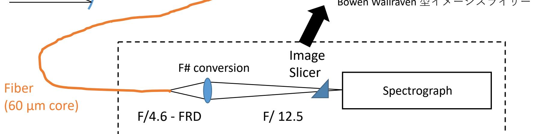
真空チャンバー (光学系全体を 180K, カメラ光学系は 60K に冷却)
